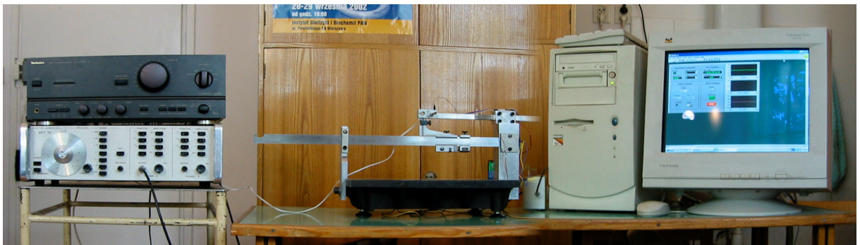
Rys.9. Stanowisko do badań sterowania kształtu konstrukcji
