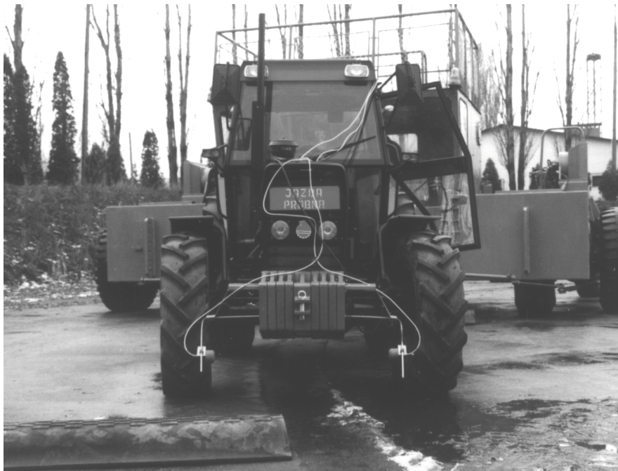
Rys.2. Badania traktora URSUS w PIMB z układem sterowania automatycznego
