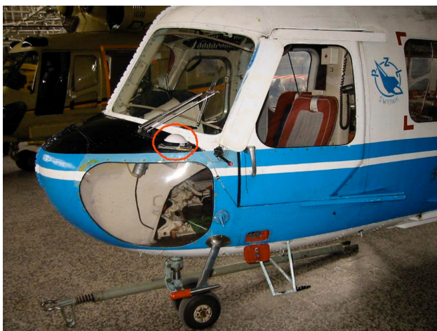
Rys.6. Miejsce zamocowania anteny GPS na śmigłowcu Mi-2
