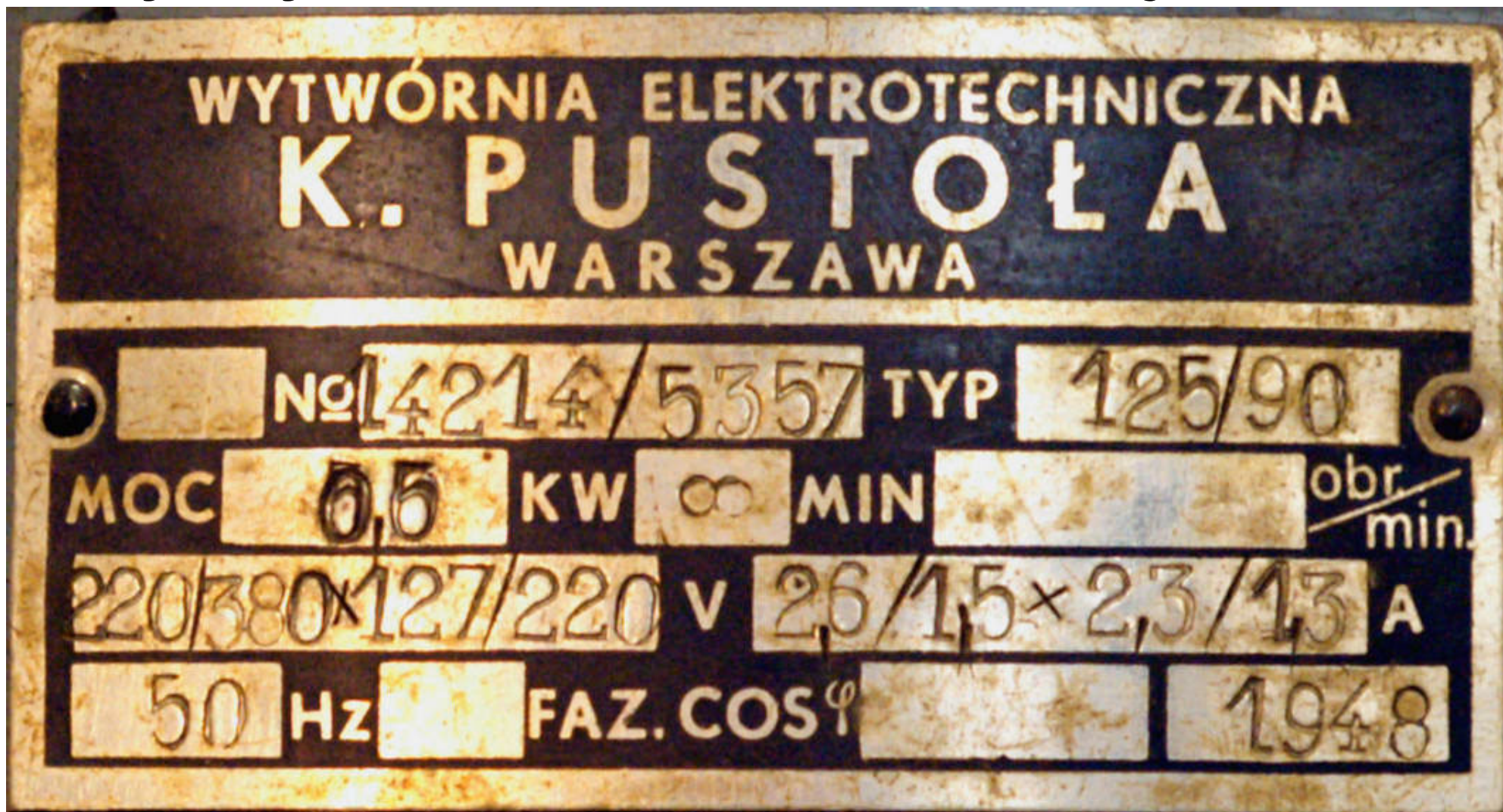
Rys.9. Tabliczka znamionowa przesuwника fazy
