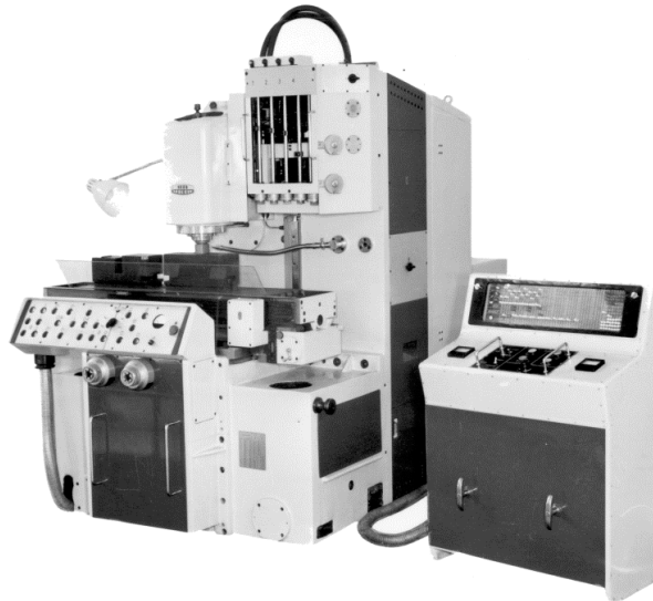
Rys.5 Frezarka wspornikowa FYA41 z układem sterowania numerycznego kształtowego SPF 100
