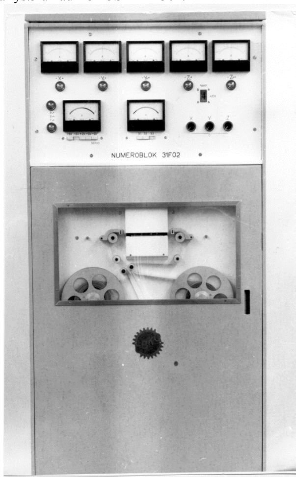
Rys.2 Układ sterowania numerycznego 3-osiowy kształtowy NUMEROGLOK 31FO2
